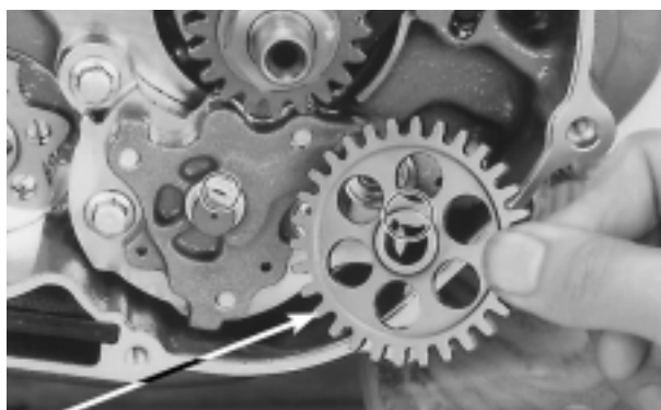
ENGRANAJE MANDADO DE LA BOMBA DE ACEITE ANILLO TÓRICO ESPIGA DE GUÍA
